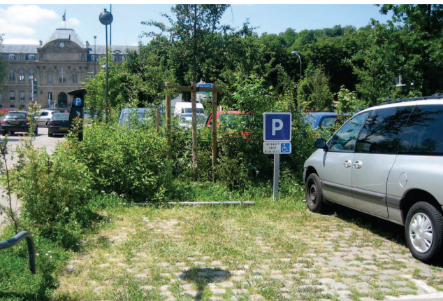
Cloisonnement des stationnements par le végétal, revêtement perméable...
